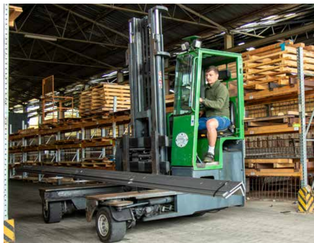
Baujahr 2002 und immer noch bestens in Schuss: Der erste von Huck verkaufte Combilift – ein C4000. Der multidirektionale Seitenstapler ist prädestiniert für das Arbeiten im Rauch-Stahlager. Produktiver und einfacher sind die langen Lasten nicht zu transportieren. Traglast: 4.000 kg, Hubhöhe: 4.040 mm, multidirektionale Lenkung
