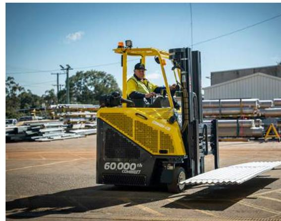
Der 60.000ste Combilift ist ein CB3000 mit 4,9 m Triplex-Mast und einer 3050 mm Langguttraverse.
