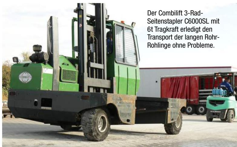
Der Combilift 3-Rad-Seitenstapler C6000SL mit 6t Tragkraft erledigt den Transport der langen Rohrrohlinge ohne Probleme.
