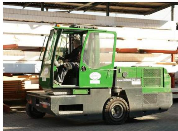
**li.:** B+M lagert Waren in bis zu sechs Metern Höhe; Hier ist Präzision und Konzentration gefragt. Durch das transparente Fahrerschutzdach und die automatische Mastschwingungsreduzierung werden derartige Arbeiten vereinfacht.
