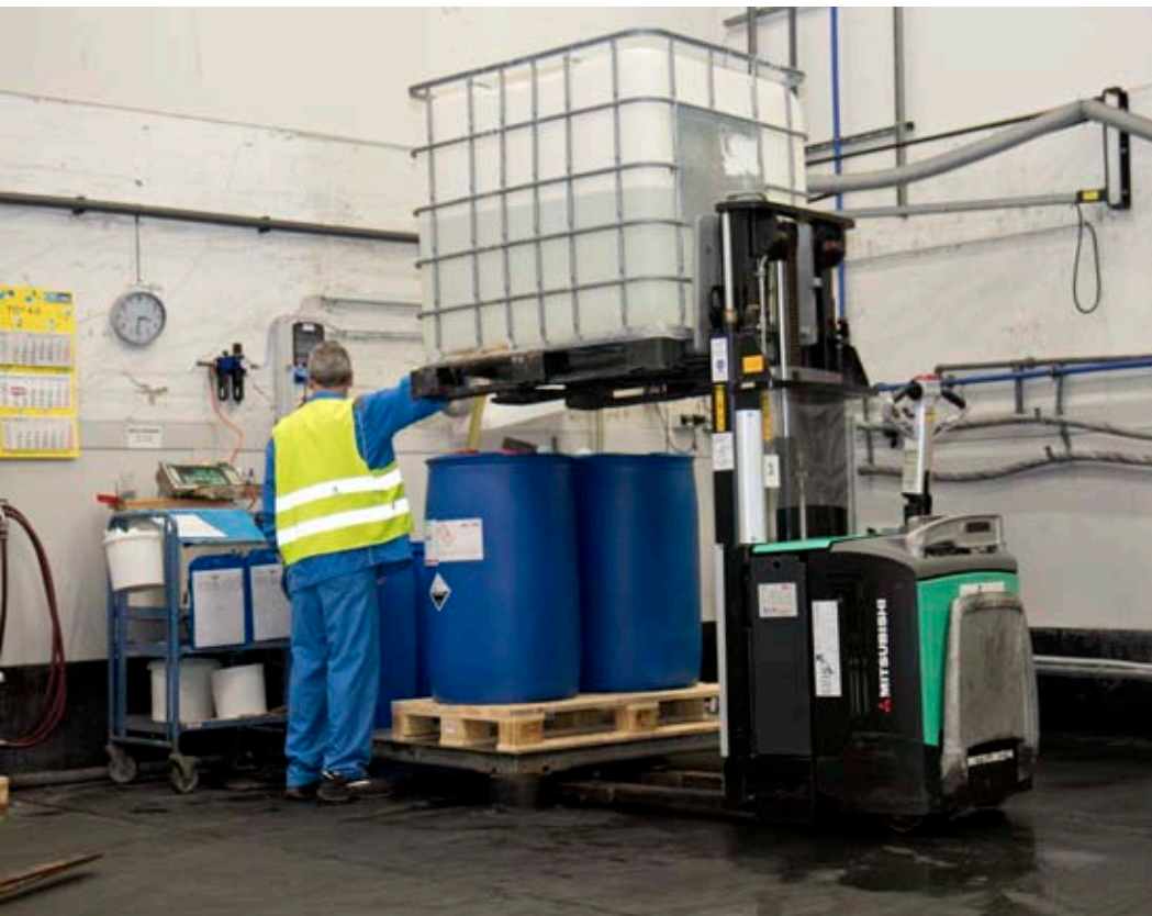
Umfüllen einfach gemacht. Der SBV16N Mitsubishi Hochhubwagen hat keine Probleme mit dem IBC Container mit 1.000 Liter Füllvolumen.
