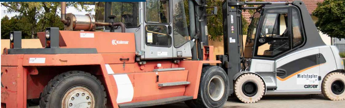
**Kalmar DCD 160-12 / 16-Tonner Diesel oder Carer A100X / 10-Tonner Elektro**
