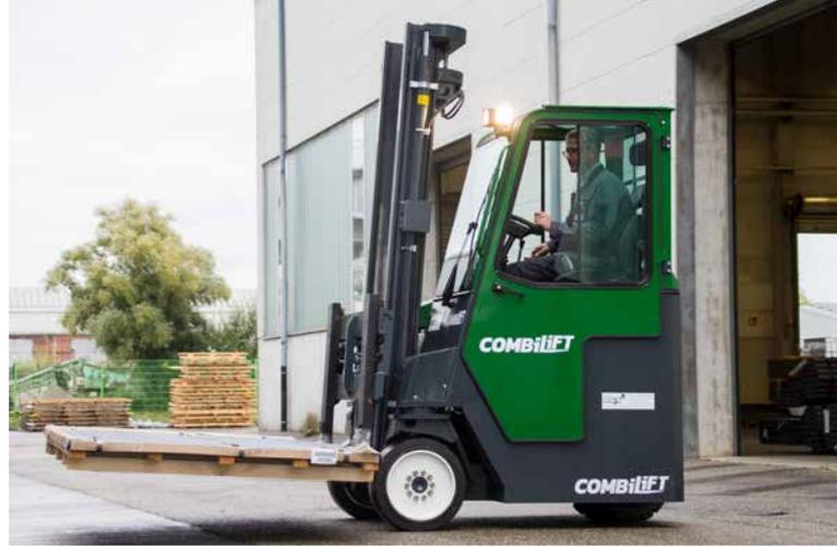
Gebaut für starke Leistung, auch über lange Strecken wie hier im Außenbereich, erspart oft zeitraubendes Umladen: Der C4000CB nimmt das Langgut auf und transportiert es via Querfahrt (erstes Bild links) aus der Halle und wechselt dann wieder in den normalen Fahrmodus.
