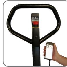
Die Kippfunktion wird durch die Kabelfernbedienung gesteuert.
